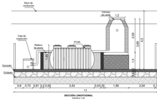
Debido a la lejanía de la infraestructura con quebradas o cuerpos de agua capaces de recibir aguas de vertimientos, todas las aguas residuales, serán tratadas en la **PTAR** y posteriormente se realizará el vertimiento de las mismas mediante un **campo de infiltración**.
